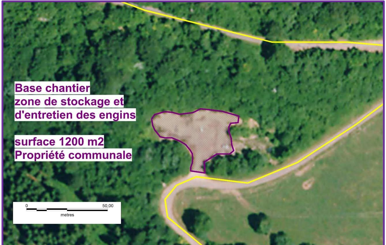
Figure 52: Accès principal au chantier en jaune et base principale chantier (base n°1).
